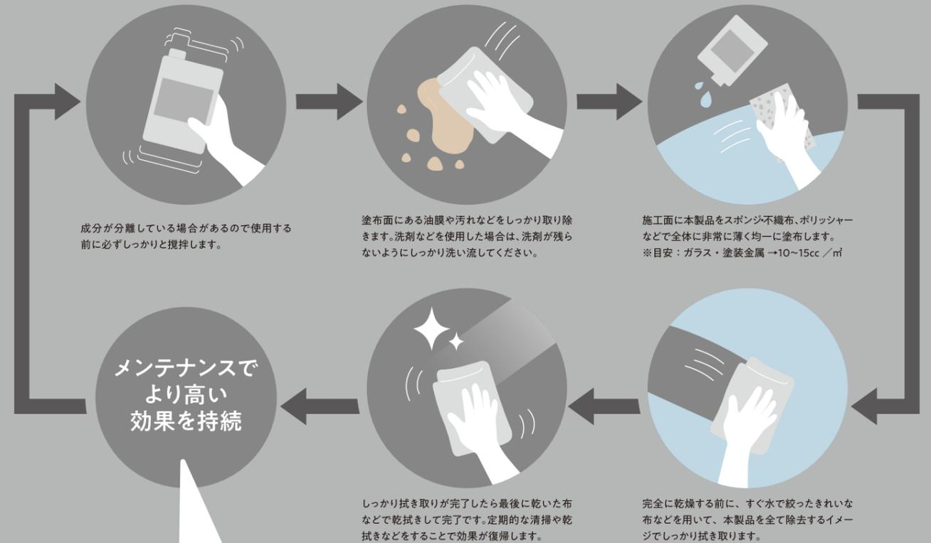
素材に悪影響がおよばないようなイオン電荷による反発レベルのために、時間の経過とともに徐々に反発力が低下し、汚れが目立ってくる場合がありますが、水洗いもしくは水で薄めた中性洗剤を用いて洗浄することで容易に汚れが落とせ、拭き上げることにより塗布時の効果が蘇ります。また、定期的に再塗布などのメンテナンスによって効果が長期間持続します。（再塗布は非常に簡単になります）
