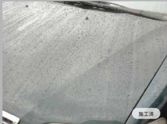
試験対象素材:車両金属塗装面、樹脂面（施工後6年経過）
